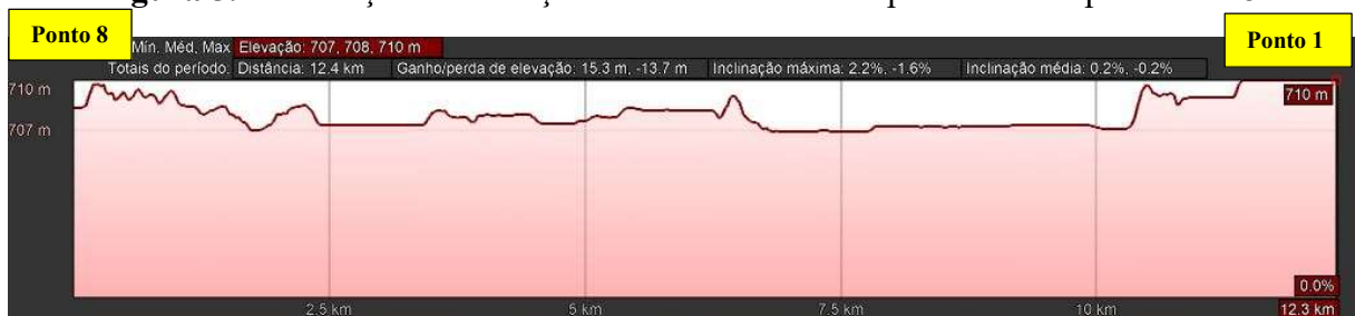
Figura 5. 2: Variação da elevação do leito do rio Paraopeba entre os pontos 1 e 8.
