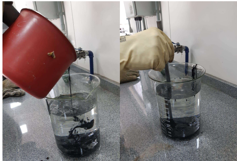
Figura 5. 3: Simulação do Piche aquecido sendo colocado em contato com a água e sendo movimentado com o auxílio de uma haste de aço inoxidável.
