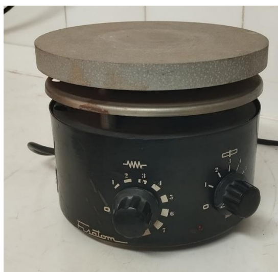
Figura 4.28 - Agitador magnético (Fisatom).
