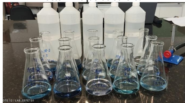
Figura 5.34 - Amostras após titulação para determinação de dureza.
