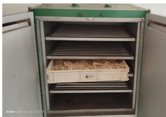
Figura 4.24 - Estufa Fanem com circulação de ar forçado utilizada para secagem do bagaço de cana.
