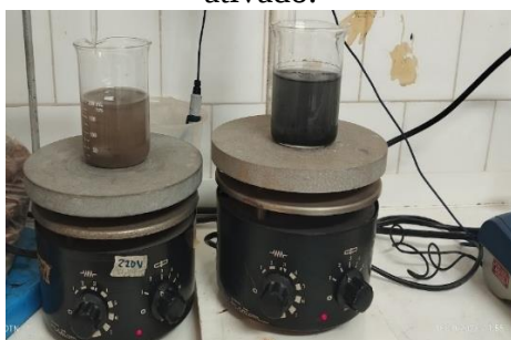
Figura 4.36 - Testes de adsorção em agitador magnético da argila e do carvão ativado.
