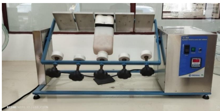
Figura 4.25 - Processo de ativação do EDTA em agitador rotativo.
