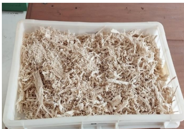
Figura 4.22 - Bagaço de cana preparado para secagem em estufa.
