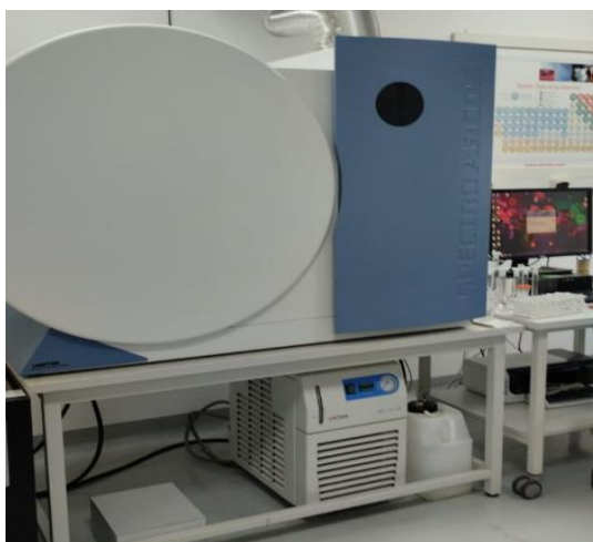
Figura 4.41 - Espectrômetro de emissão atômica com plasma de argônio indutivamente acoplado (ICP OES), marca Spectro.
