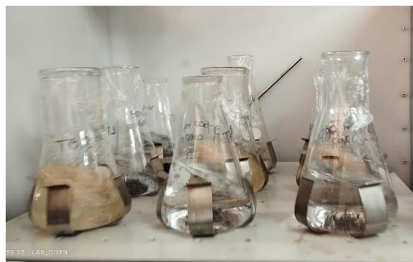
Figura 4.33 - Amostras em processo de agitação em Shake.
