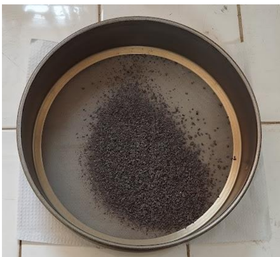
Figura 4.21 - Argila expandida com granulometria entre 0,25 mm e 2mm.
