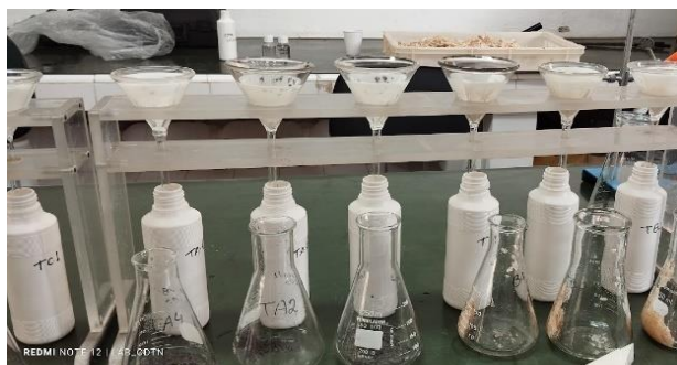
Figura 4.34 - Filtração das amostras após processo de agitação.
