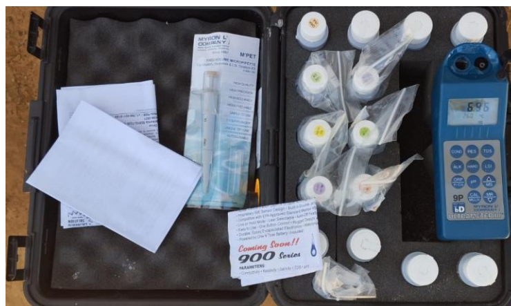
Figura 4.5 - Medidor Ultrometer III 9P da marca Myron L.
