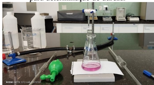
Figura 5.32 - Amostras antes da titulação para determinação de dureza.
