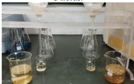
Figura 4.38 - Filtração após agitação por 5 horas.
