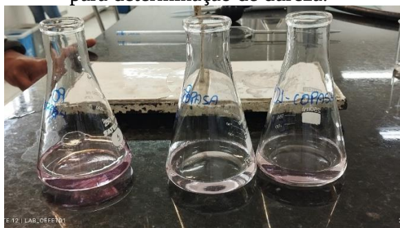
Figura 5.31 - Amostras antes da titulação para determinação de dureza.
