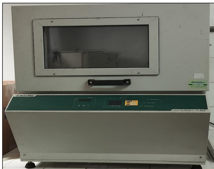
Figura 4.27 – Incubadora shaker de bancada com refrigeração (Nova Ética, modelo 430 RDB).
