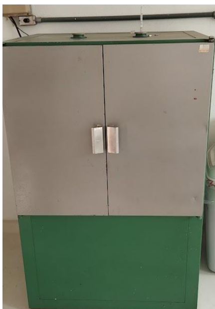
Figura 4.24 - Estufa Fanem com circulação de ar forçado utilizada para secagem do bagaço de cana.
