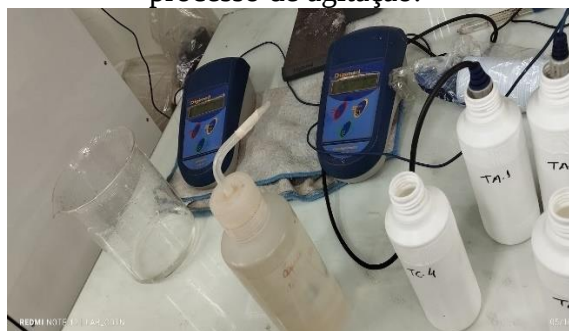
Figura 4.35 - Medição dos parâmetros de condutividade e pH das amostras após o processo de agitação.
